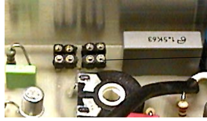
Kuvassa suodinkondensaattoreiden SIL-kannat
