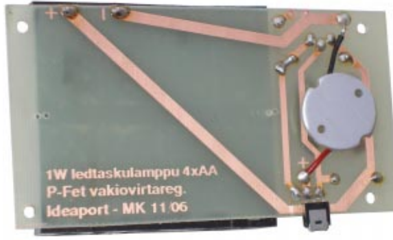
Kuva piirilevyn alta, jossa ovat jäähdytystä tarvitseva led ja fet-transistori (fetistä suurennos)
