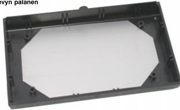
Kuva kotelosta K10, jonka pohjalle on leikattu alumiinilevyn palanen
